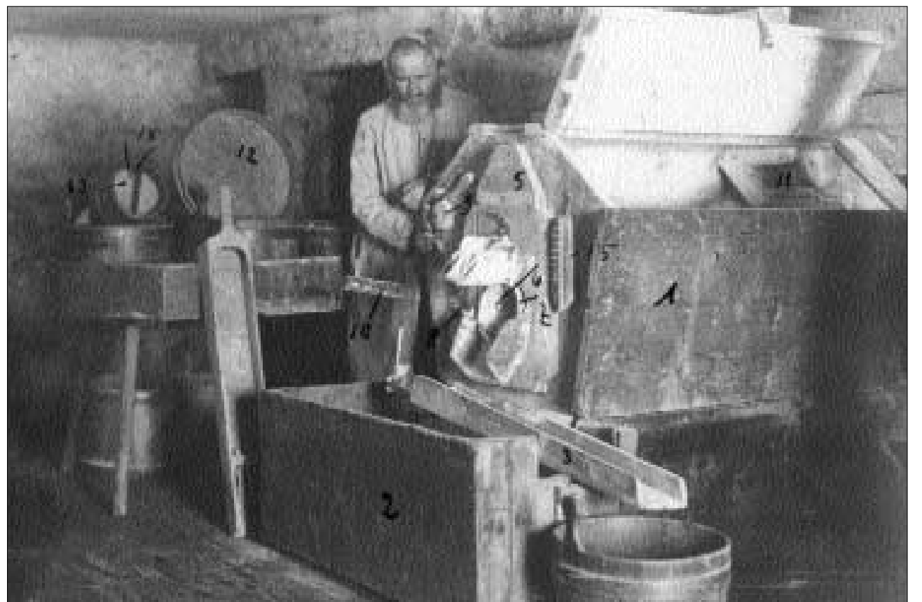
Mulin da graun a Tscherv cun intgins indrizz (1922). 1 chascha da farina o chascha dal biat – 2 chascha da las laidias o da las cristgas – 3 crivel – 4 ster (na sco masira).
