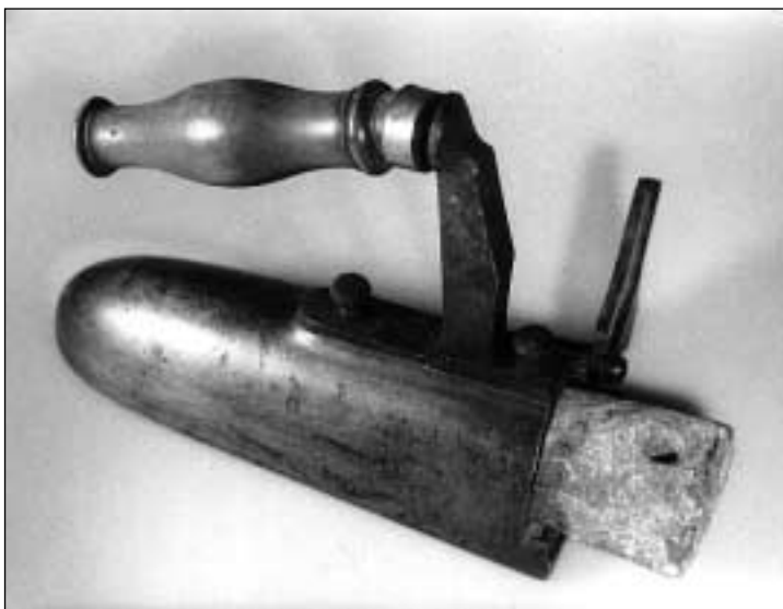
Fier da crap. Quest fier è vid endadens ed ha a l'interiur in crap u in toc fier che vegn tut or per vegnir stgaurà. Qua è il toc da mez in crap.
