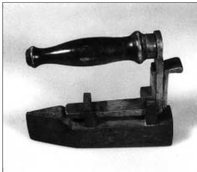
Fier da cusunzas u fier da cusadiras. Tar quest fier prend'ins davent il moni per stgaurar il pe ch'è da fier massiv.
